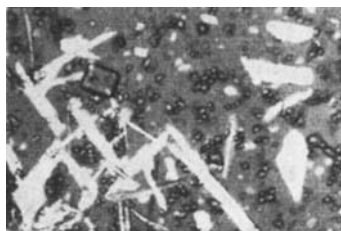
Fig. 2e. \text{CaH}_4(\text{PO}_4)_2 \cdot \text{H}_2\text{O} = \text{Ca}^{\text{I}} (plaques claires). \text{Ca}(\text{NO}_3)_2 \cdot \text{NH}_4\text{NO}_3 = \text{D}^{1-1-0} (petits cristaux + 1 cube). \text{NH}_4\text{NO}_3 = \text{NH}_4^{\circ} (aiguilles).
